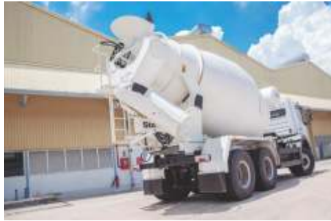
Xe trộn bê tông - Concrete mixer trucks
